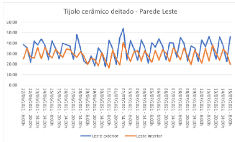
Figura 5. Temperatura interna e externa da parede leste do protótipo 1. Fonte: Acervo dos Autores.
